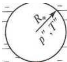
Рис. 3.4. Пузырек в перегретой жидкости
