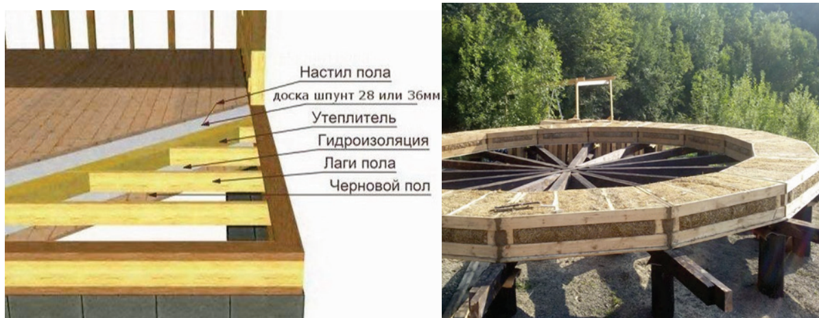
Рисунок 6 – Конструкция пола для глэмпинга
