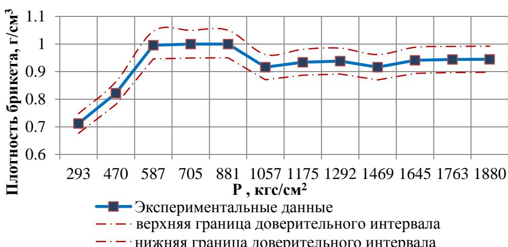
Рисунок 1 – Зависимость плотности брикета от давления прессования
