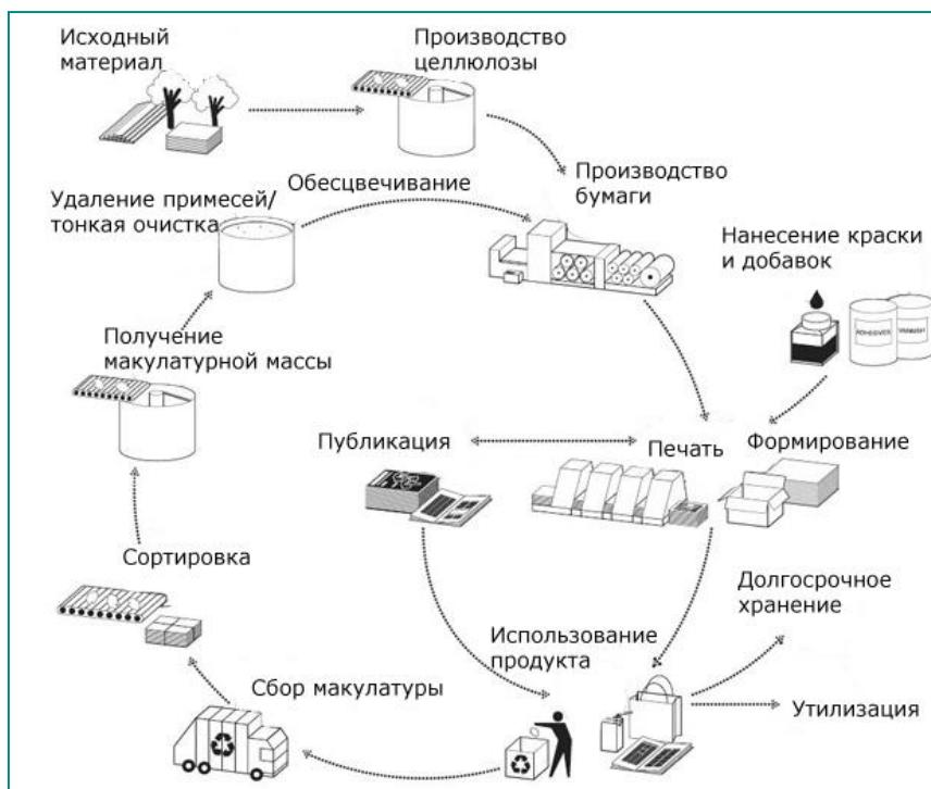
Рисунок 2 – Схема процесса переработки макулатуры
