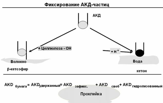
Рисунок 4 - Схема процесса проклейки бумаги и картона kleями на основе АКД
