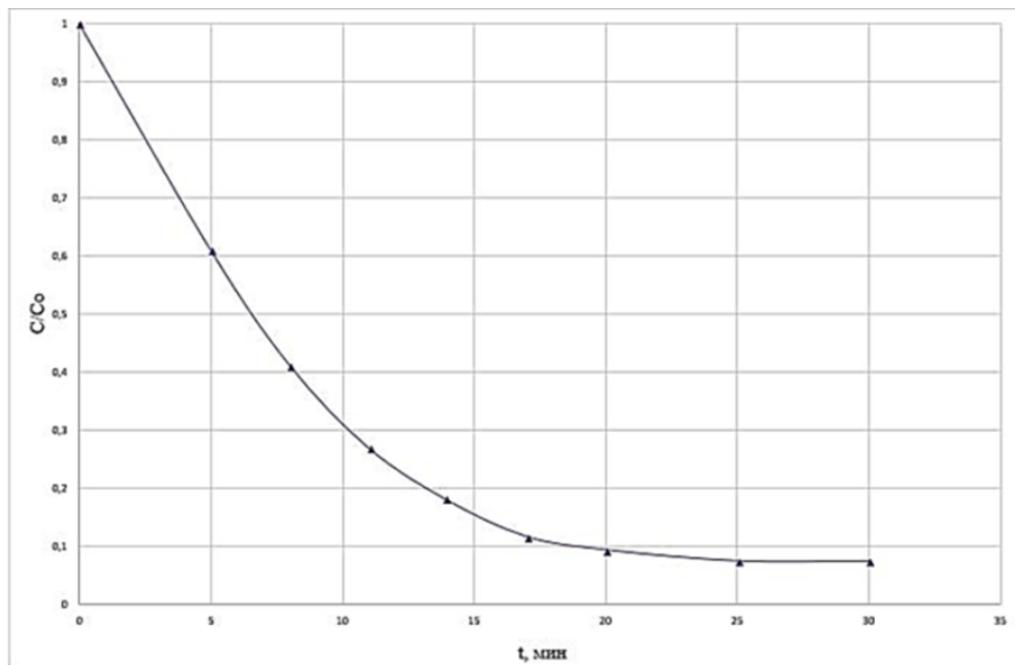
Рисунок 5 - Кинетика фотокаталитического окисления метиленового голубого под действием нанокомпозита МКЦ –  $\text{TiO}_2$ :  $C_0$  – исходная концентрация красителя,  $C$  – концентрация красителя в процессе разложения
