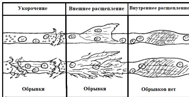
Рисунок 1 - Действие ножей на волокна в процессе размола
