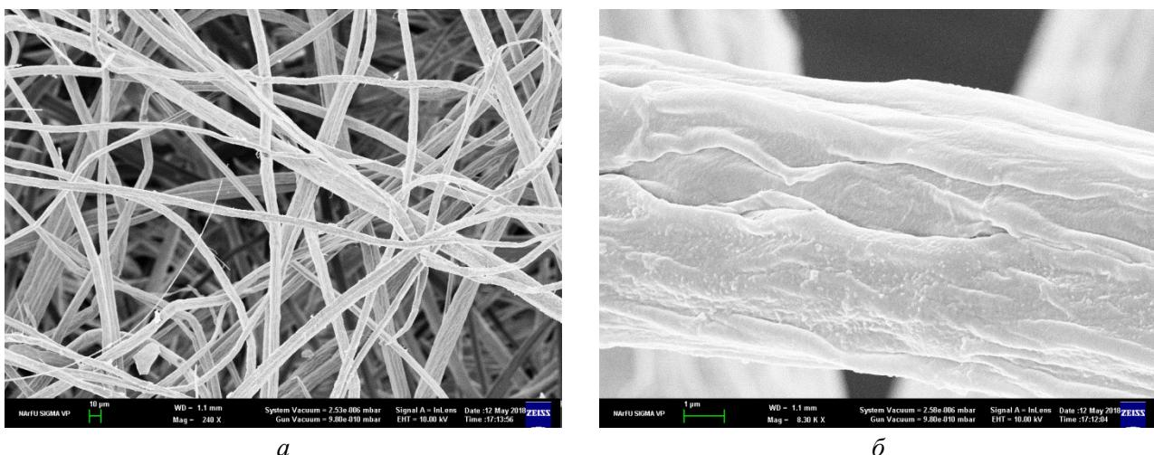
Рисунок 1 - Микрофотографии образцов бамбуковой целлюлозы (получены на электронном микроскопе Zeiss SIGMA VP): *а* – волокна; *б* – поверхность волокна
