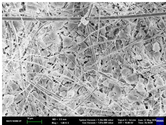
Рисунок 1 – Микрофотография структуры композитного материала на основе стеклянных волокон
