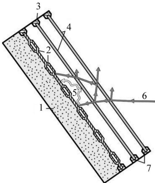
Рисунок 1 – Схема "плоского" солнечного коллектора: 1 – изоляция; 2 – лучевоспринимающая поверхность; 3 – кожух; 4 – стекло; 5 – излучение лучевоспринимающей пластины; 6 – солнечные лучи; 7 – уплотнитель
