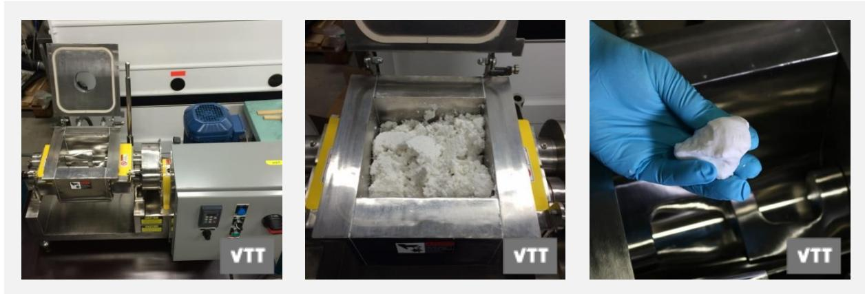
Рисунок 1 - Внешний вид наноцеллюлозы, получаемой с применением технологии HefCel
