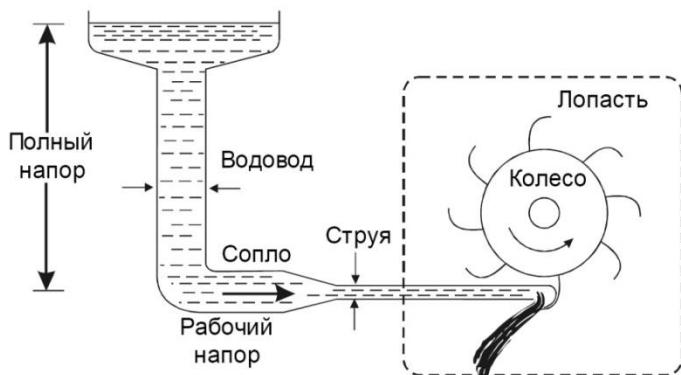
Схема работы активной турбины Пелтона
