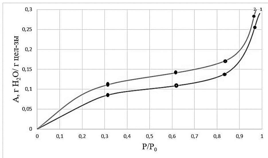
Рисунок 4 – Изотермы сорбции паров воды: 1 – кривая сорбции МКЦ, 2 – кривая сорбции гибрида МКЦ –  $\text{TiO}_2$
