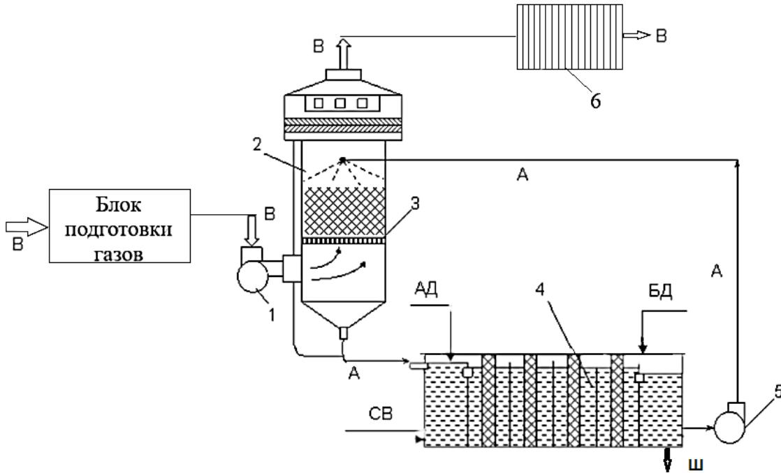
Рисунок 2 – Схема комбинированной очистки низкоконцентрированных выбросов от дурнопахнущих веществ: 1 – вентилятор; 2 – абсорбер (скрубер); 3 – массообменная решетка; 4 – биореактор; 5 – насос, 6 – фильтр; А – циркулирующий абсорбент; В–вентиляционный воздух; АД – абсорбент; БД – биогенные добавки; СВ – сжатый воздух, Ш – шлам
