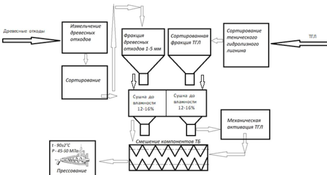
Рисунок 4 – Инновационная схема производства топливных брикетов из лесосыревых отходов
