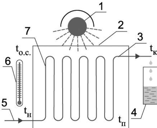
Рисунок 2 – Схема установки: 1 – лампа (имитирующая солнце); 2 – кожух коллектора; 3 – слив воды из коллектора; 4 – мензурка; 5 – подача воды в коллектор; 6 – термометр; 7 – трубы коллектора
