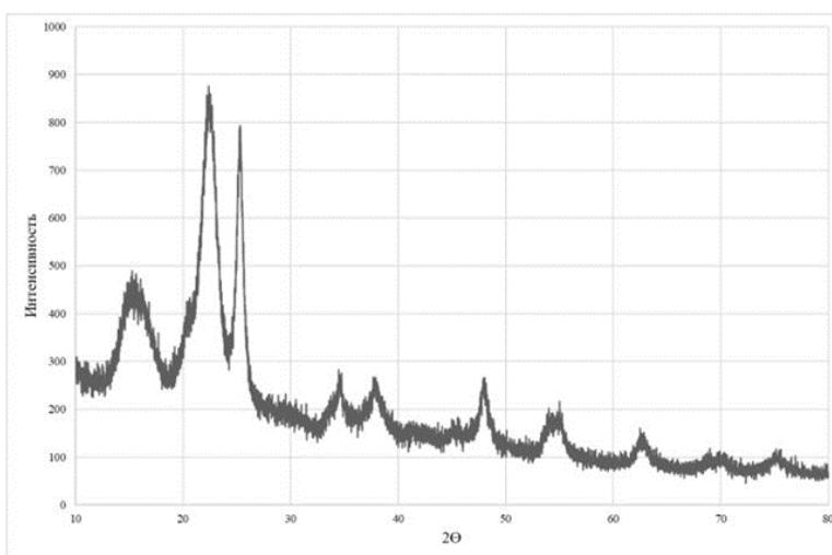
Рисунок 3 - Рентгенограмма нанокомпозита МКЦ – оксида титана
