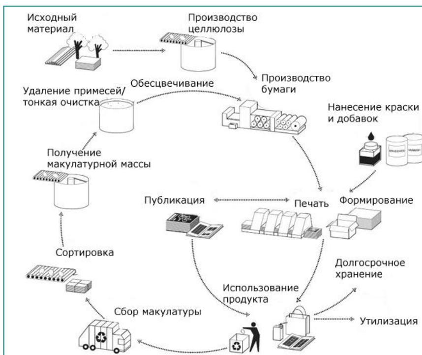
Рисунок 2 – Схема процесса переработки макулатуры
