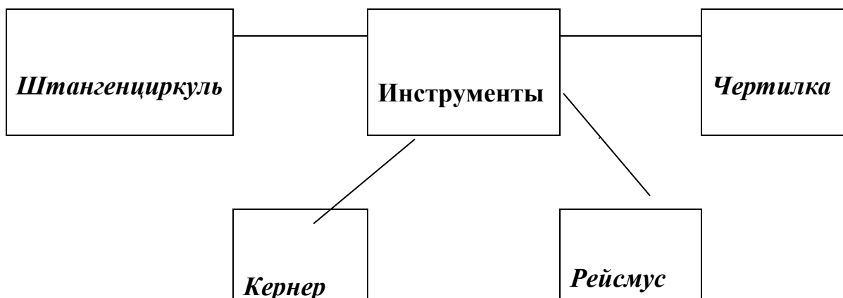
Рисунок 2.4 – Инструменты для плоскостной разметки
