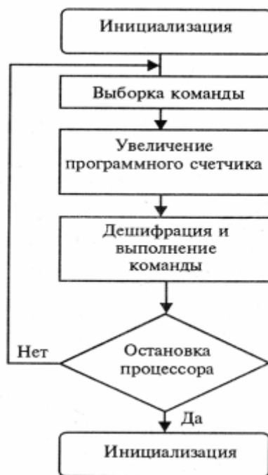
Рисунок 6 – Алгоритм функционирования ЭВМ с шинной архитектурой
