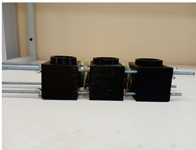
Рисунок – Лабораторная установка для проведения электродиализа
