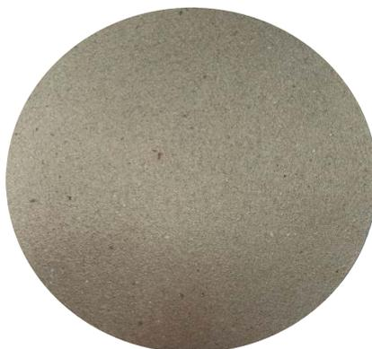
Рисунок 3 – Отливка из костры льна и макулатуры
