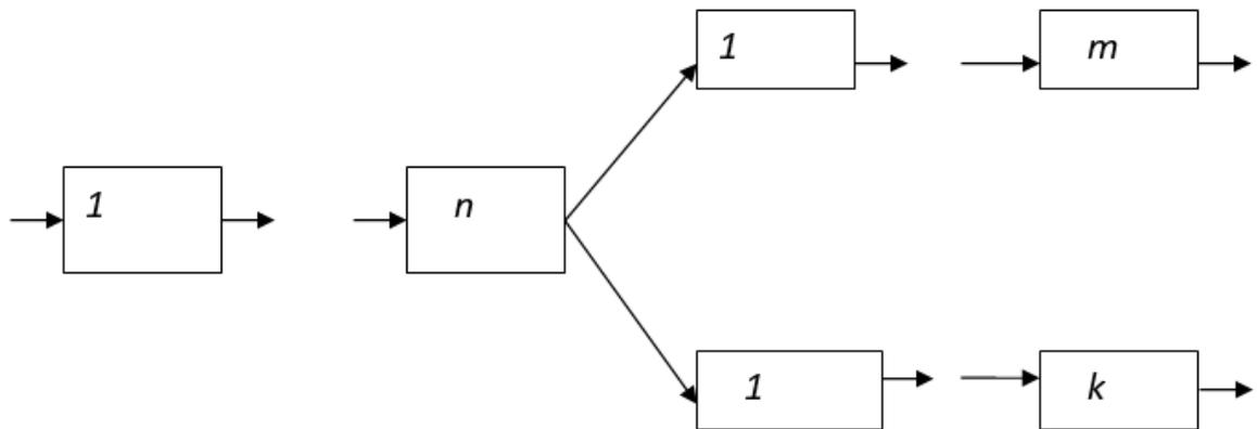
Рисунок 3.6 – Принципиальная схема разделительного многоступенчатого процесса
