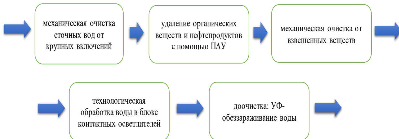
Рисунок 1. Схема основного технологического цикла Колпинской водопроводной станции
