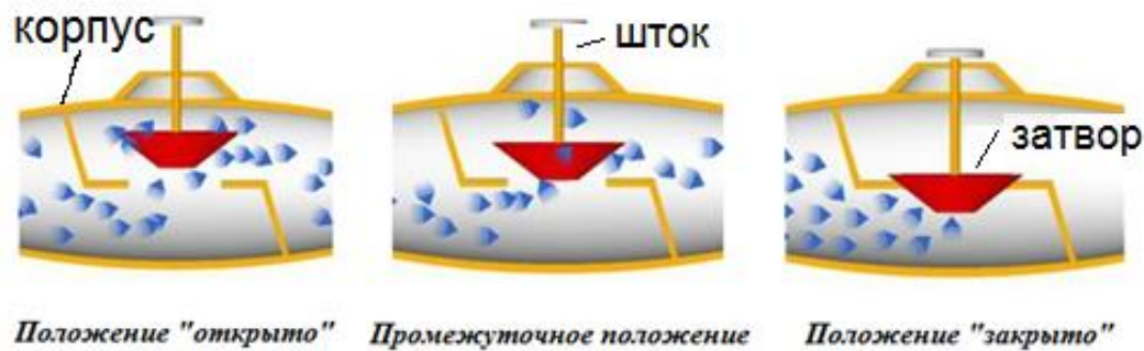
Рисунок 3 – Положения затвора клапана
