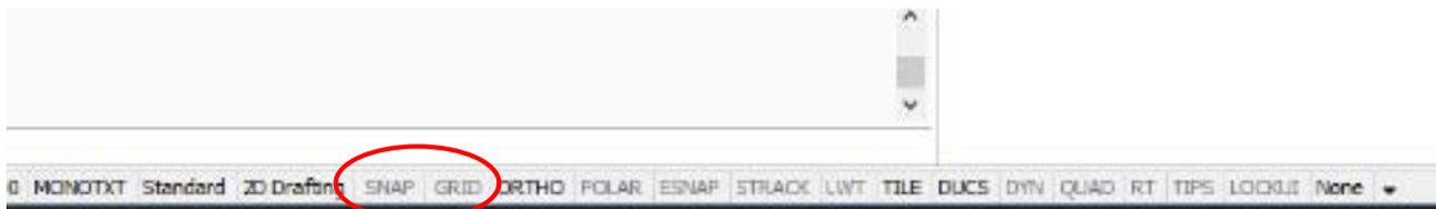
Рисунок ПР1.40 – Инструменты SNAP и GRID
