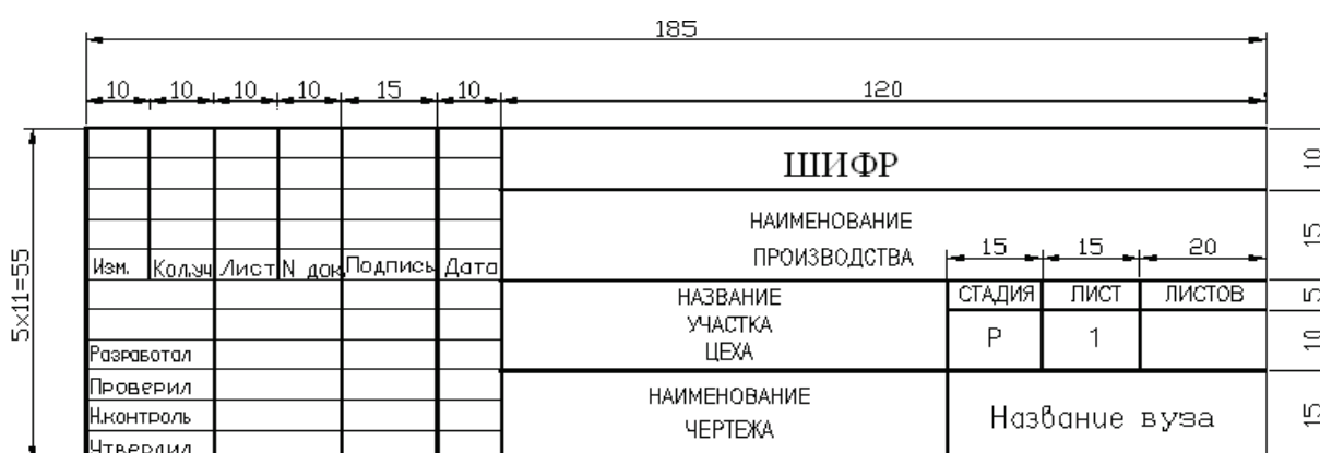
Рисунок 1 – Основная надпись для чертежей и схем ГОСТ 2.104-68
