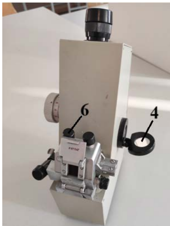
Рисунок 9 – Внешний вид рефрактометра Аббе ИРФ-454Б: 1 – корпус; 2 – маховик компенсатора дисперсии; 3 – маховик поворота шкалы; 4 – зеркало; 5 – окуляр измерительная призма, 6 – рукоятка осветительной призмы; 7 – шторка осветительной призмы; 8 – шторка измерительной призмы
