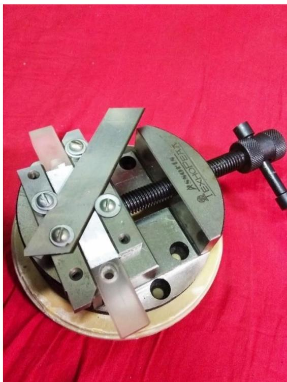
Рисунок 1 – Установка для нарезки образцов нужной толщины и техника резания целлюлозы на основе берёзы
