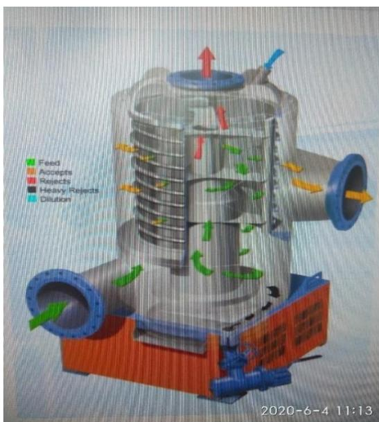
Рисунок 4 – Устройство современной сортировочной машины
