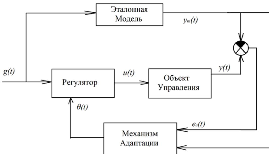
Рисунок 7 – Схема системы адаптивного управления
