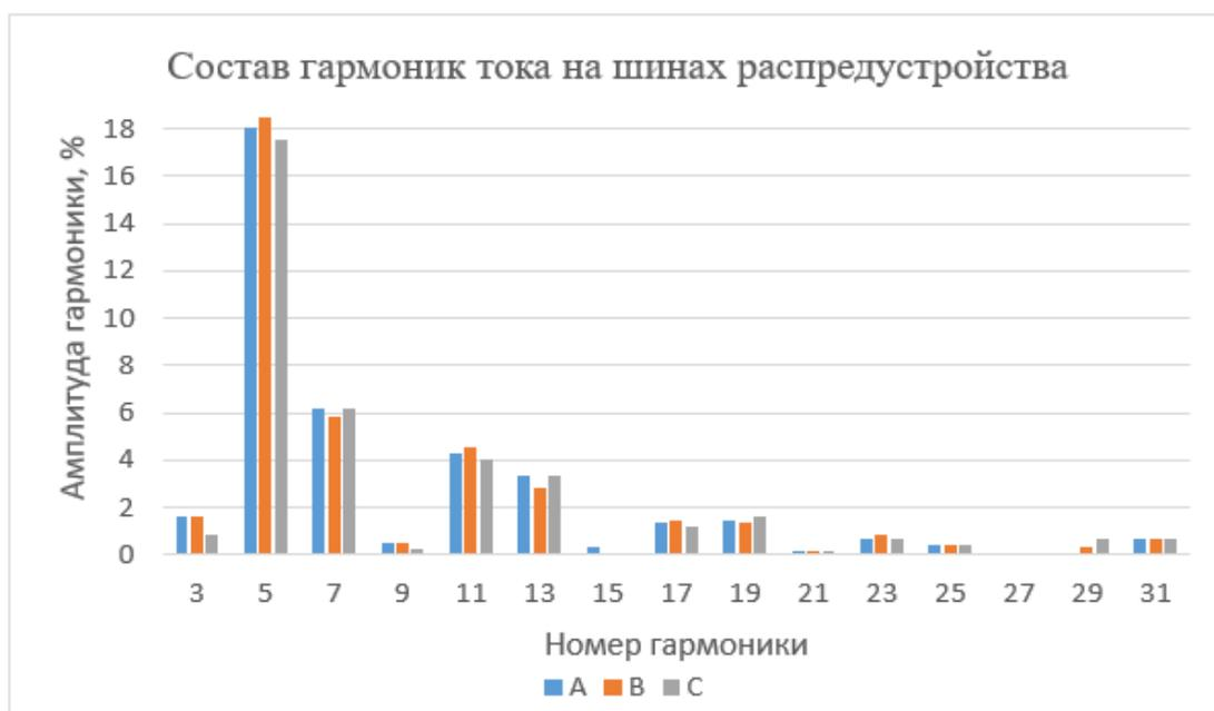
Рисунок 1 – Состав гармоник тока на шинах распределительного устройства
