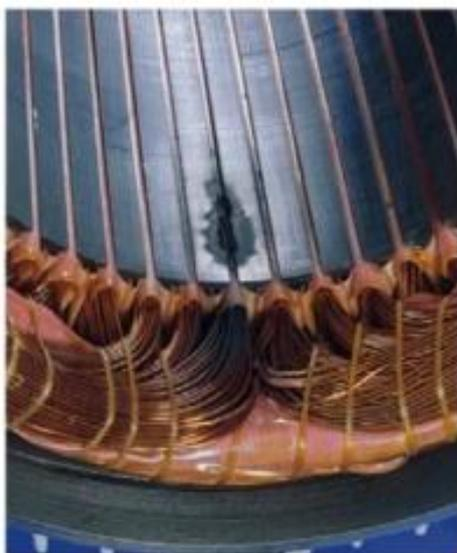
Рисунок 1 – Межвитковое замыкание обмотки статора
