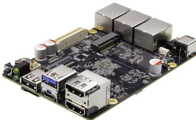
Рисунок 3 – Одноплатный компьютер Firefly ROC-RK3588-RT
