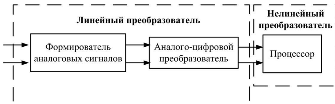
Рисунок 3.2 – Обобщенная структурная схема цифрового измерительного органа
