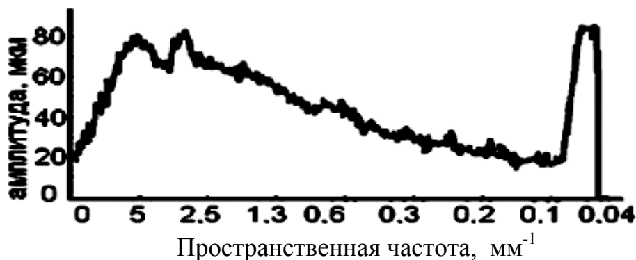
Рис. 2.9. Амплитудный частотный спектр функции яркости бумаги в проходящем свете
