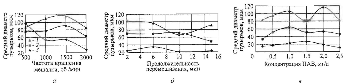
Рис. 3. Влияние числа оборотов мешалки (а), продолжительности перемешивания (б) и концентрации ПАВ (в) на средний диаметр пузырьков пены: 1 – спустя 10 мин после отключения мешалки; 2 – 5 мин; 3 – сразу после отключения
