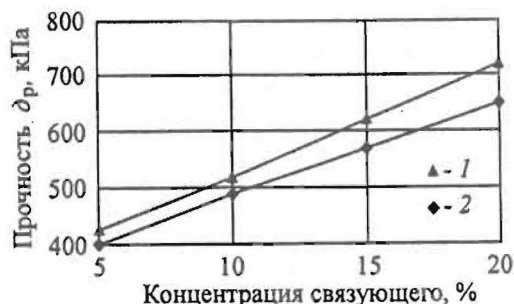
Рис. 5. Зависимость прочности от способа формования (концентрация ПАВ – 1,4 мг/л): 1 – пенный способ; 2 – классический способ
