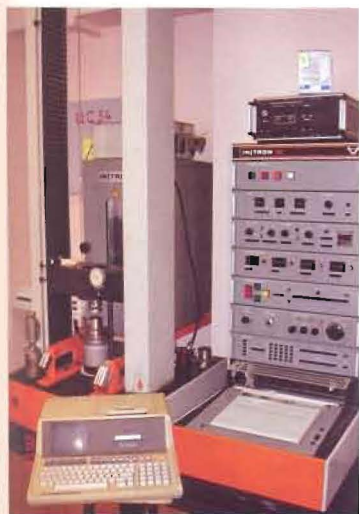
Рис. 1. Установка «Инстрон-1121» 1983-1984 гг. выпуска до реконструкции. На переднем плане компьютер, совмещенный с принтером фирмы HP марки HEWLETT PACKARD 85B
