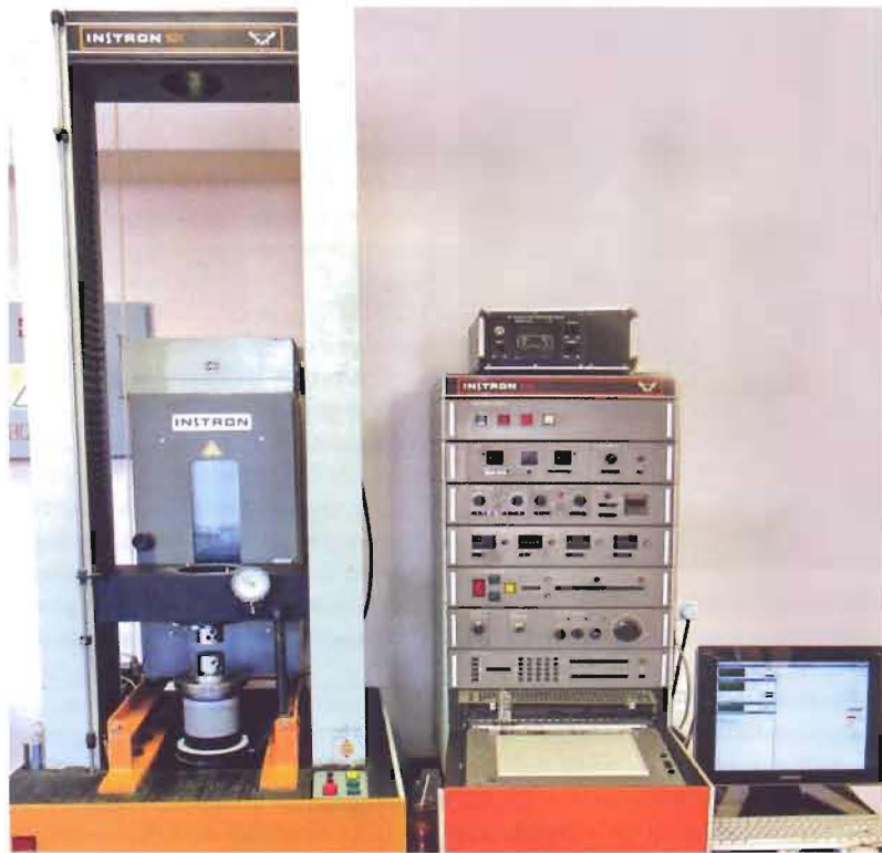
Рис. 3. Программно-аппаратный комплекс на основе инновационной реконструкции универсальной исследовательской установки «Инстрон-1121», подготовленный к испытаниям древесины в режиме сжатия.
