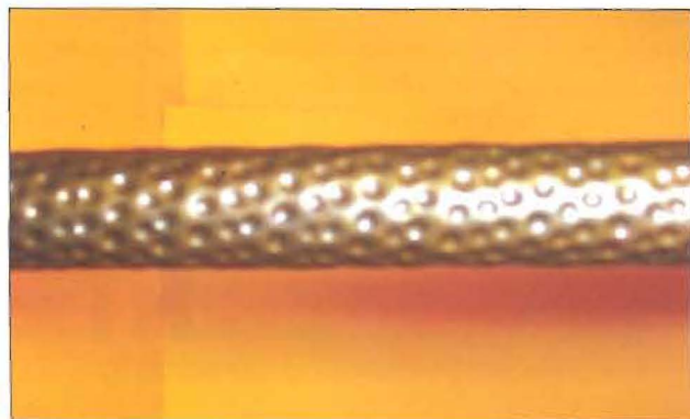
Рис. 1. Олуненная теплообменная трубка.
