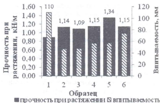
Рис. 3 - Зависимость прочности и впитываемости образцов бумаги при раздельной обработке целлюлозных волокон полиэлектролитами
