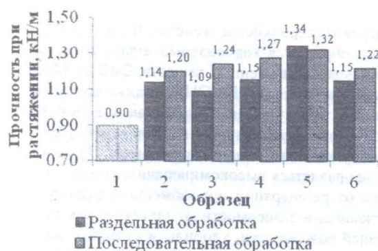
Рис. 4 - Прочность при растяжении в зависимости от дозировки полиэлектролитов при раздельной и последовательной обработке целлюлозных волокон
