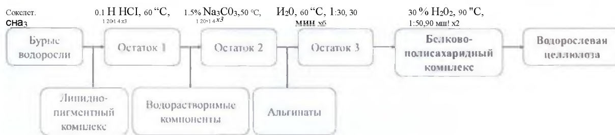
Рис. 1. Схема получения водорослевой целлюлозы
