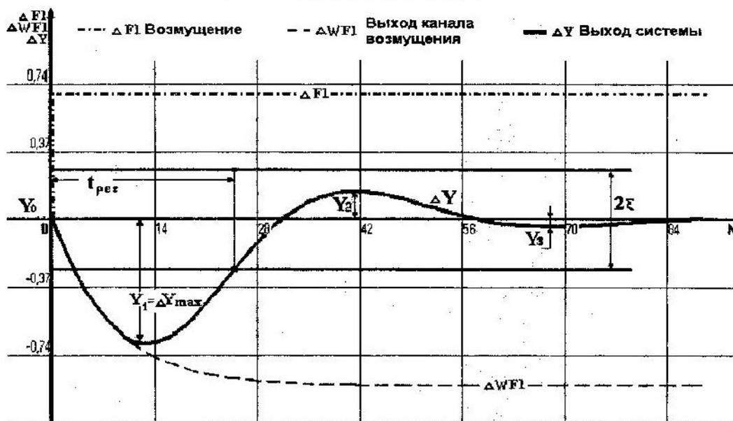
Рис.П.8.1. Переходный процесс при возмущении на выходе канала возмущения объекта (система астатическая, линейная)
