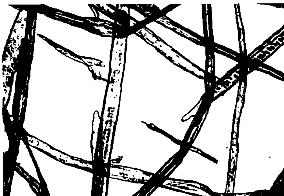
Рис. 2.1. Микрофотография волокон сульфатной целлюлозы ели
