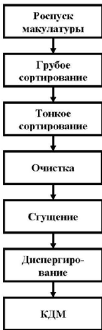
Рис. 11.1. Стандартная схема подготовки макулатурной массы из использованной гофрокартонной тары
