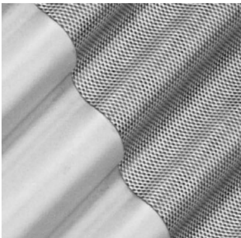
Рис. 9.3. Бессеточный сектор Baglees дискового фильтра
