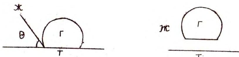
Рис. 3.13. Схема отрыва пузырька от поверхности твердого тела
