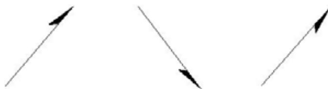
Рис. 44. Обозначение швов с помощью линий-выносок
