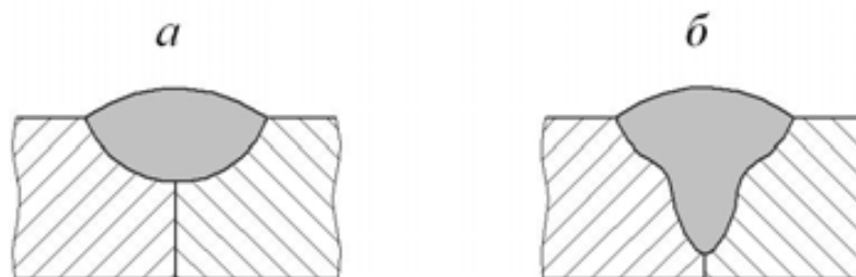
Рис. 15. Форма проплавления для обычной и плазменной дуги: а – для обычной дуги; б – для плазменной дуги
