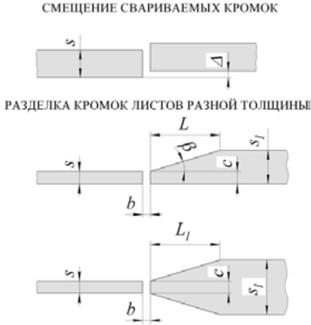
Рис. 33. Подготовка кромок при соединении листов разной толщины
