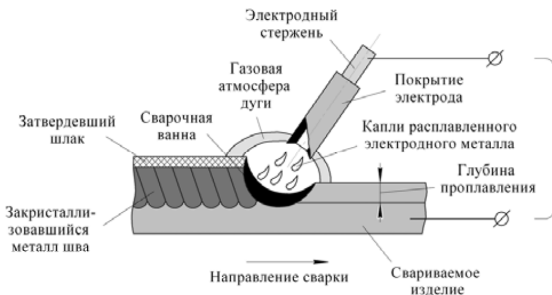
Рис.2. Схема процесса ручной дуговой сварки
