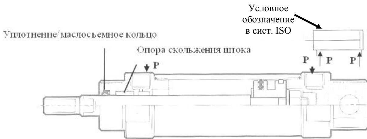
Рис. 1.1.3. Типовой цилиндр двустороннего действия
