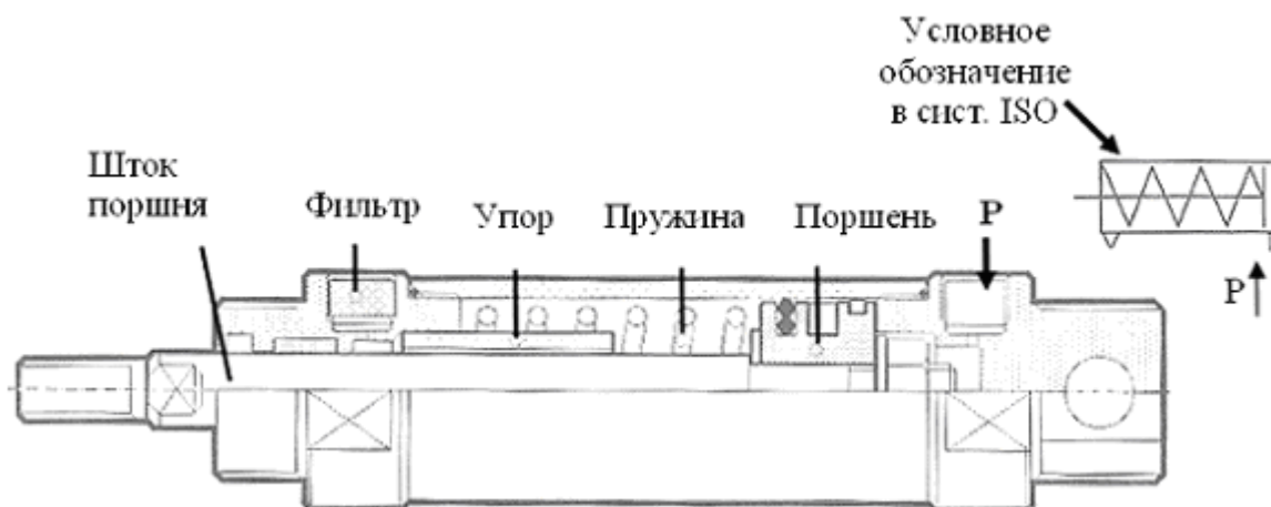
Рис. 1.1.1. Типовой цилиндр одностороннего действия
