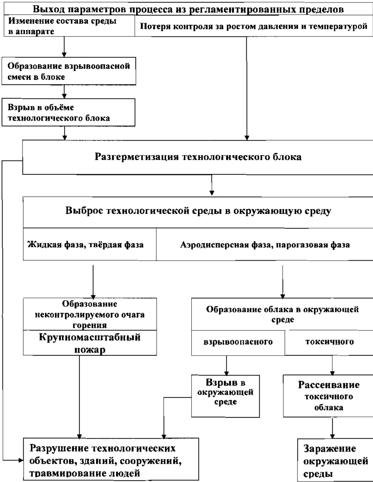
Рис. 1. Типовая модель развития аварий на химико-технологических объектах
