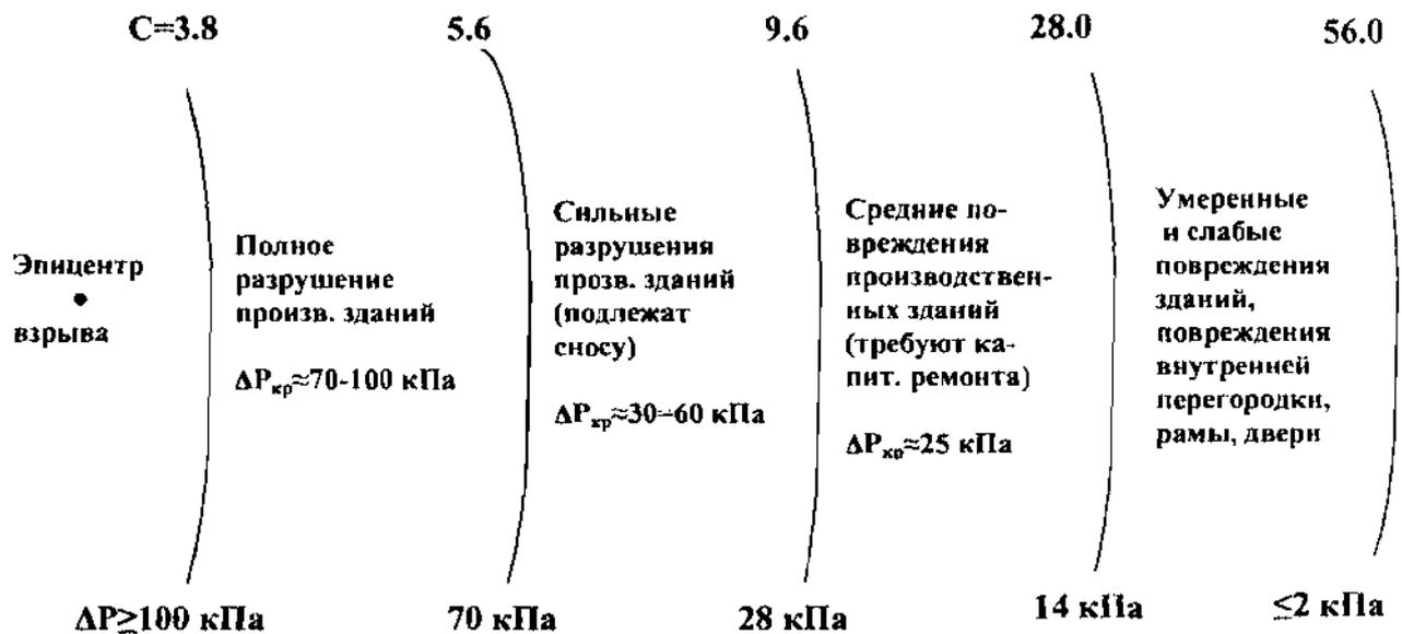
Рис.2. Зоны разрушительного воздействия ударной волны
