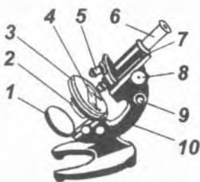
Рис. 11. Оптический микроскоп: 1 – зеркало, 2 – конденсор, 3 – предметный столик, 4 – предметное стекло, 5 – объектив, 6 – окуляр, 7 – тубус, 8 – макрометрический винт, 9 – микрометрический винт, 10 – штатив
