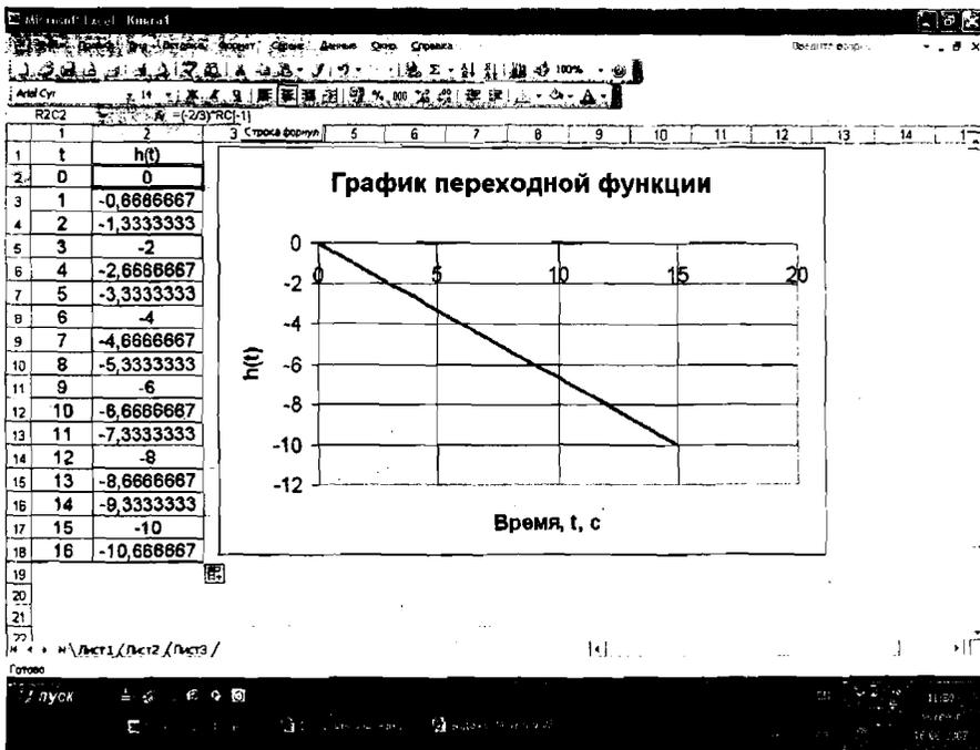
Рис.17. Экранная форма расчета переходной функции
