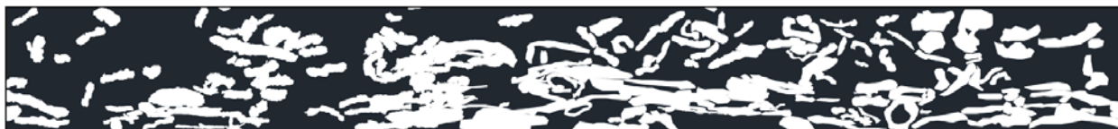
Рис. 3. Выделенные области среза волокнистого материала (в белом цвете) при работе с векторным форматом в программе AutoCAD
