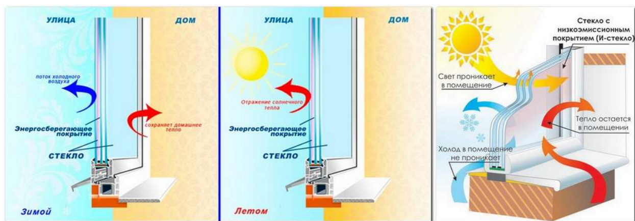
Рисунок 11.2 – Блок оконного стекла с низкоэмиссионным покрытием
