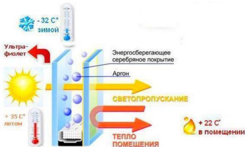
Рисунок 11.4 – Энергосберегающая камера триплекса окна с И-стеклом
