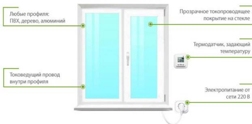
Рисунок 11.9 – Компоновка системы низкоэмиссионного окна с электрообогревом стекол
