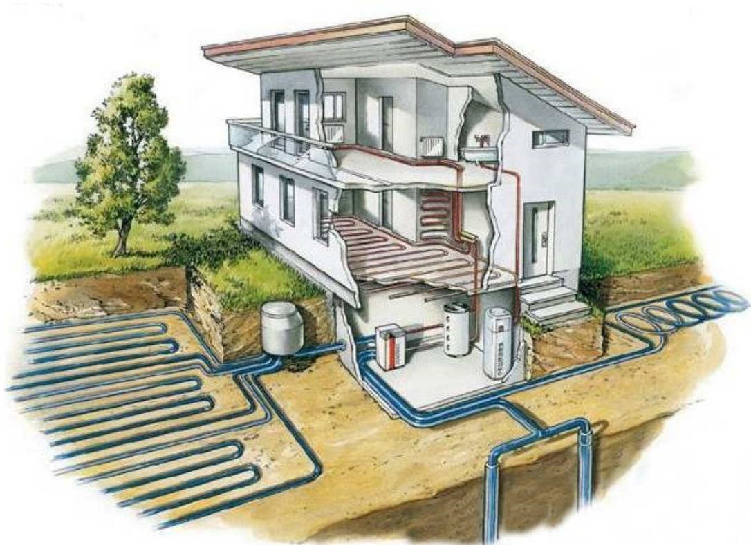
Рисунок 10.1 – Грунтовый коллектор теплового насоса
