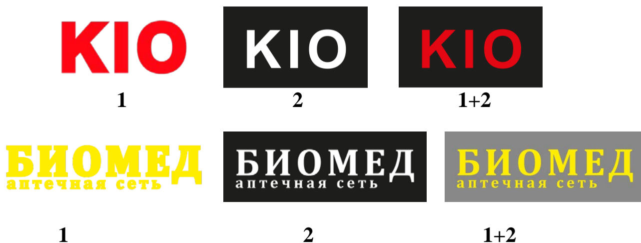
Рис. 4. Оригинал-макет логотипа для трафаретной печати 1 – первый прокат (красный) – шрифт с обводкой; 2 – второй прокат (черный); 1+2 – результат двух прокатов
