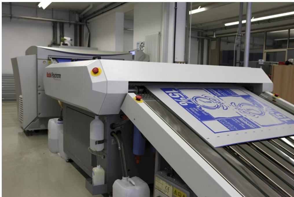
Рис. 12. Изготовление формы для офсетной печати (плоская печать)
