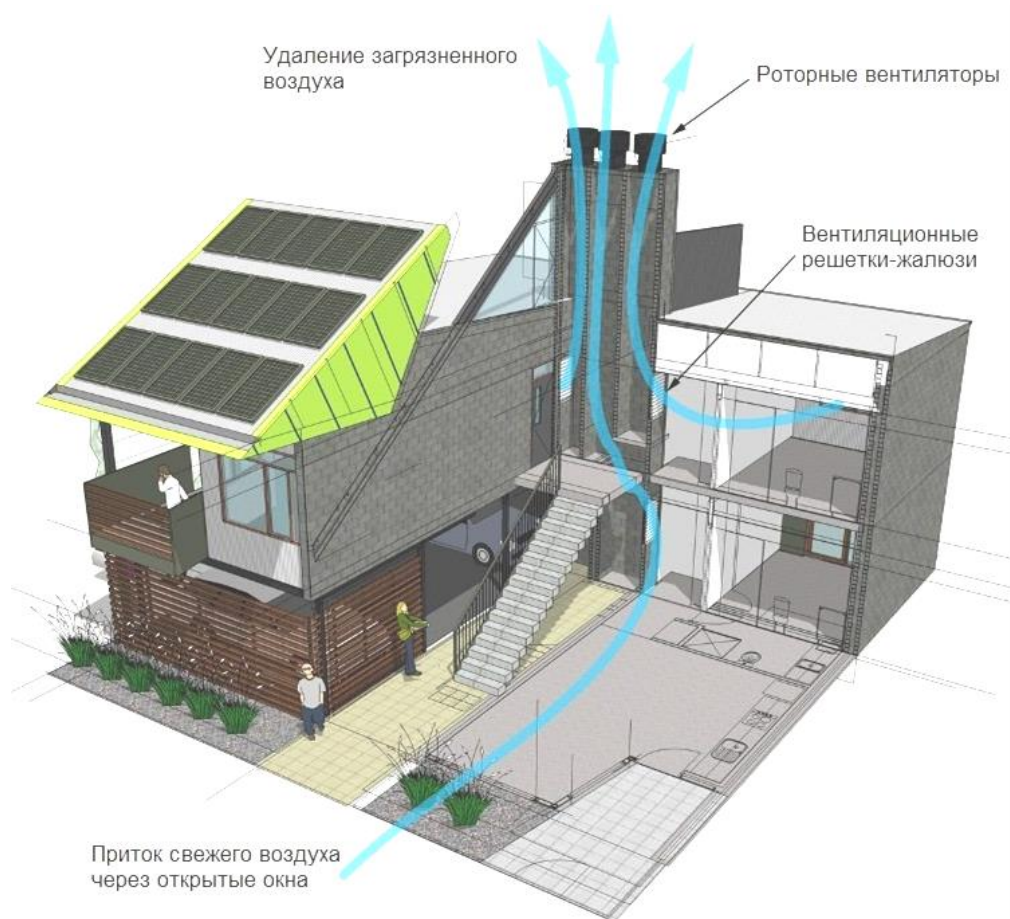
Рис. 58. Схема движения воздушного потока внутри дома при естественной вентиляции
