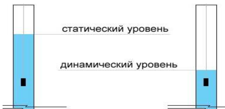
Рис.44. Статический и динамический уровни воды в скважине
