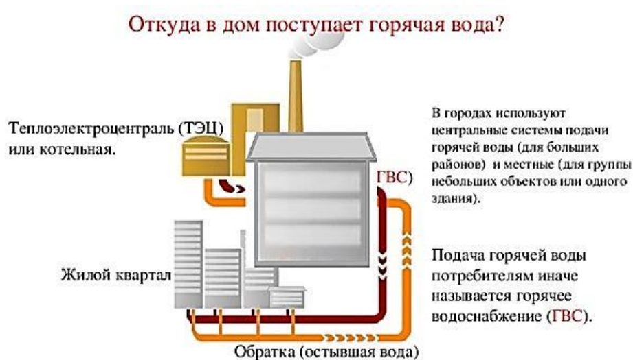
Рис.31. Схема поступления горячей воды в жилые дома
