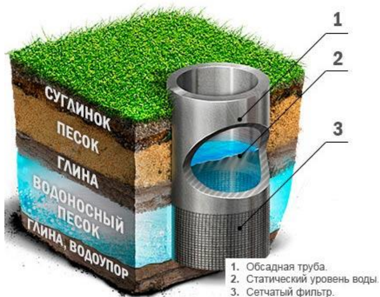
Рис.39. Конструкция песчаной скважины
