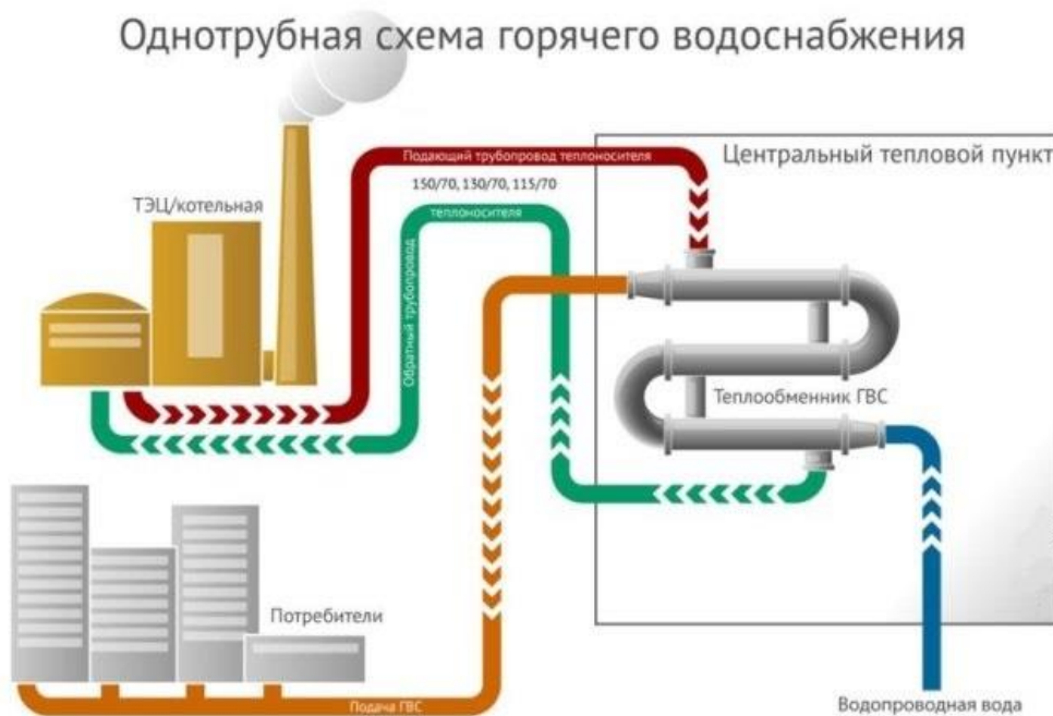
Рис.32. Однотрубная схема ГВС
