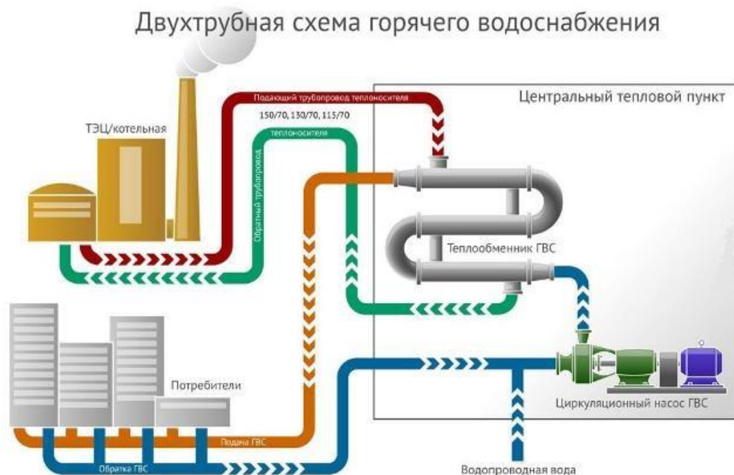
Рис. 33. Двухтрубная схема ГВС
