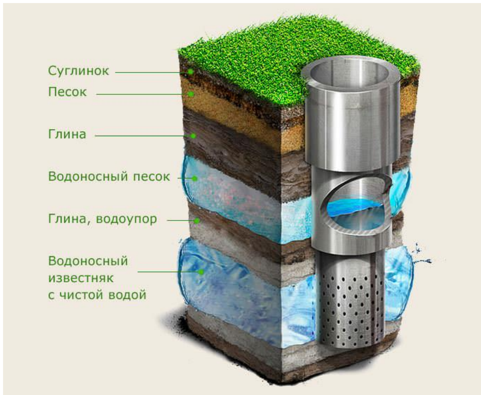
Рис.40. Конструкция артезианской скважины
