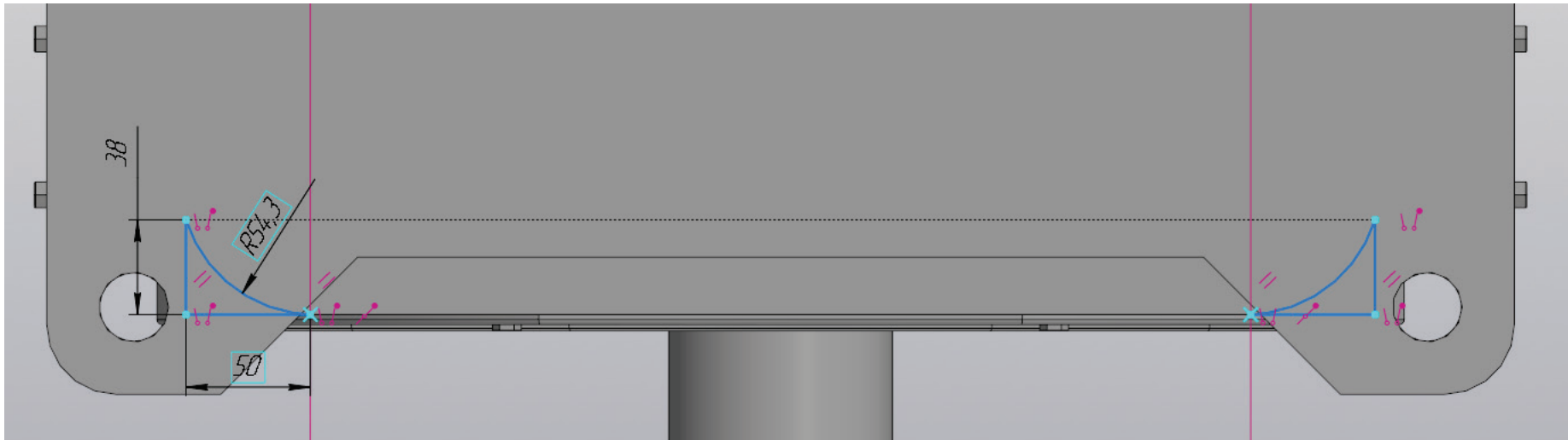
Рисунок 143 – Работа с эскизом, создание контура скругления
