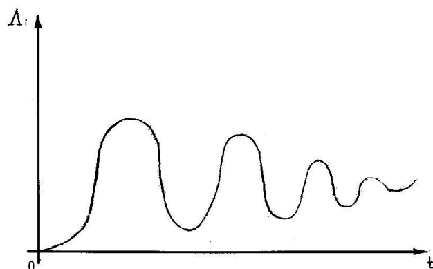
Рис. 4.4. Функция \Lambda_i(t) при восстановлении заменой (когда без замен в исходном комплекте изделий проявляется нормальный закон надёжности)
