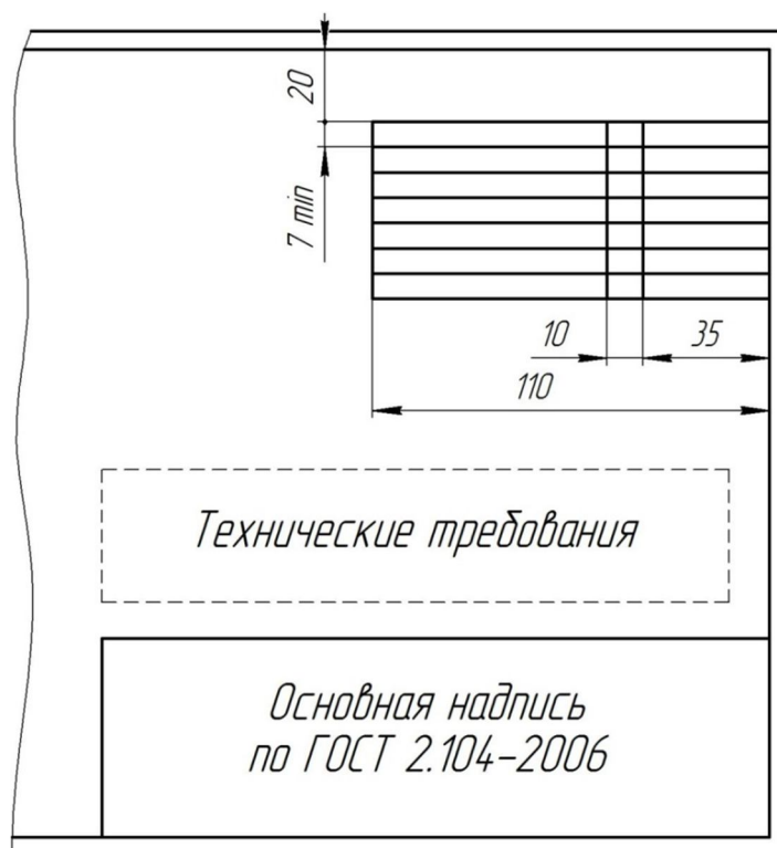
Рисунок 15 – Расположение таблицы параметров зубчатых, червячных колес и червяков и технических требований к их изготовлению на чертеже
