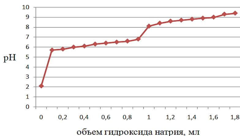
Рисунок 2 – Потенциометрическое титрование гидроксидами натрия лабораторного щелока после варки № 2 по режиму ЦБК № 1
