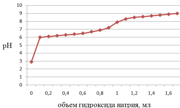
Рисунок 6 – Потенциометрическое титрование гидроксидом натрия лабораторного щелока после варки по режиму ЦБК № 2
