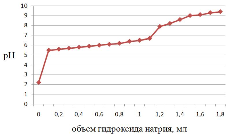
Рисунок 3 – Потенциометрическое титрование гидроксидом натрия лабораторного щелока после варки № 3 по режиму ЦБК № 1
