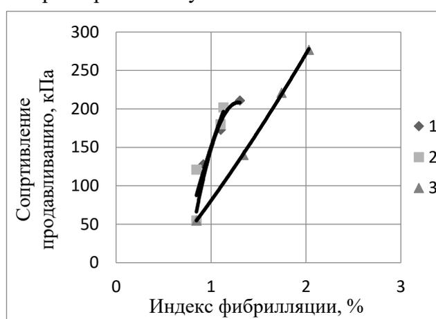
Рисунок 7 – Зависимость сопротивления продавливанию от индекса фибрилляции (гарнитура 1; гарнитура 2; гарнитура 3)
