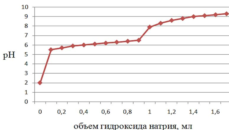
Рисунок 1 – Потенциометрическое титрование гидроксидами натрия лабораторного щелока после варки № 1 по режиму ЦБК № 1
