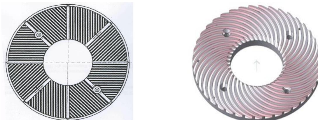
Рисунок 2 – Схема и характеристика ножевых размалывающих гарнитур:
