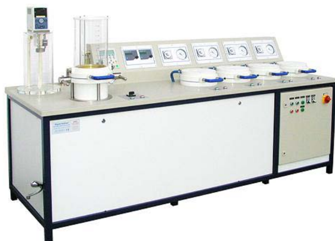
Рис. 4. Листоотливной аппарат Рапид-Кетен
