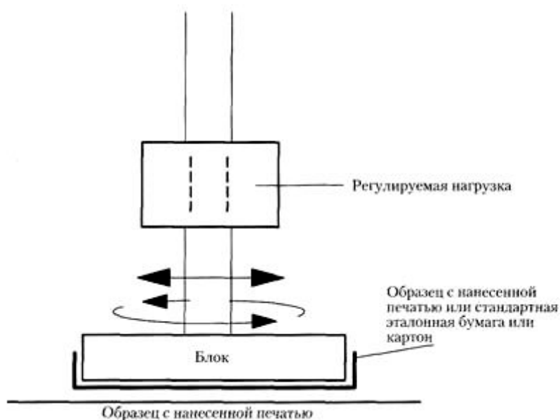
Рис. 19. Испытание на сопротивление печати истиранию
