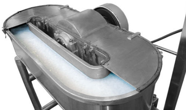
Рис. 2. Лабораторный ролл Валлея
