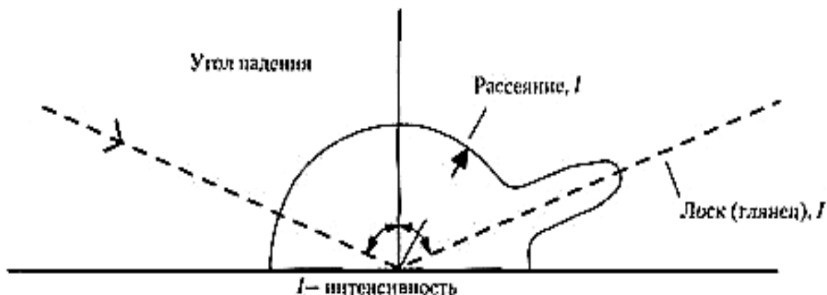
Рис. 14. Схема прохождения освещения в глянцемере
