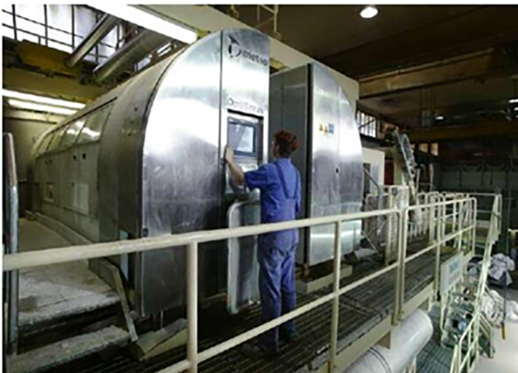
Рис. 20. Установка спрыскового мелования «Опти Спрей» (по материалам фирмы «Metso Paper»)
