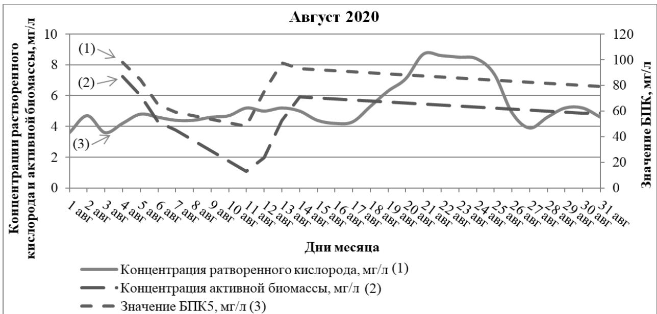
Рисунок 2 – Зависимость показателей БПК 5 , растворенного кислорода и активной биомассы за август 2020
