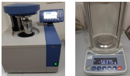
Рисунок 3 – Оборудование, используемое в ходе эксперимента (калориметрическая бомба и весы)
