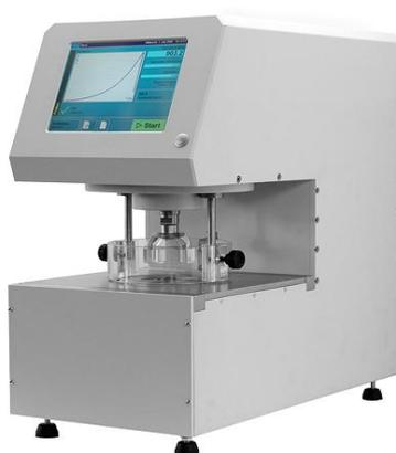
Рис. 18. Прибор для определения сопротивлению продавливанию
