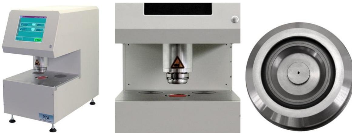
Рис. 11. Модуль для измерения шероховатости по Паркеру (Parker Print Surf)
