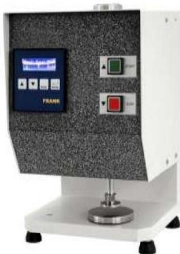
Рис. 14. Универсальный толщиномер со сменной измерительной площадкой
