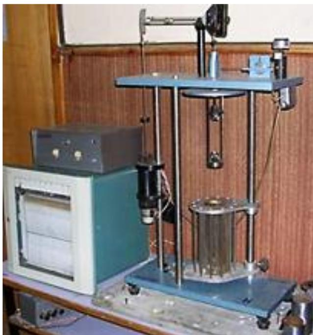
Рис. 16. Релаксометр деформаций
