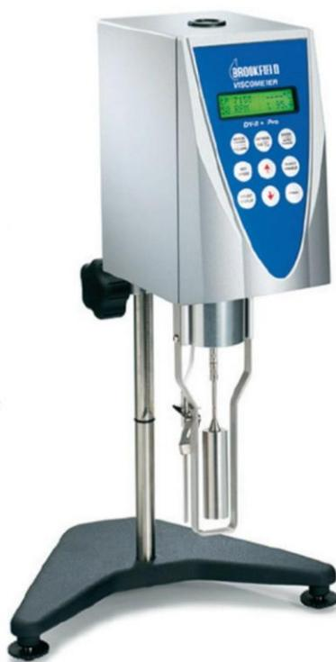
Рис. 5. Вискозиметр Брукфильда
