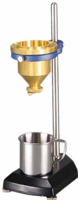
Рис. 1. Вискозиметр ВЗ-4
