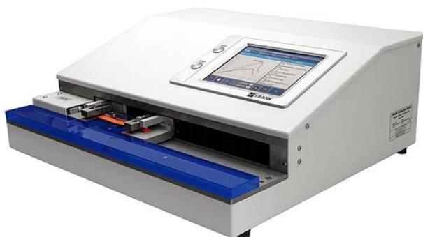
Рис. 15. Горизонтальная разрывная машин
