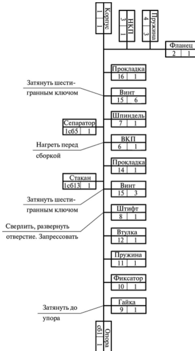
Рис. 10. Технологическая схема общей сборки задней опоры оси шпиндельного узла токарного станка: НКТ, ВКП – наружное и внутреннее кольцо подшипника соответственно
