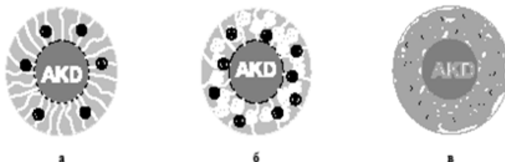
Рис. 2.9. Виды клея на основе АКД: а – защитный коллоид-крахмал, заряд 1+; б – защитный коллоид-крахмал и синтетический полимер, заряд 2+; в – защитный коллоид синтетический полимер, заряд 3+
