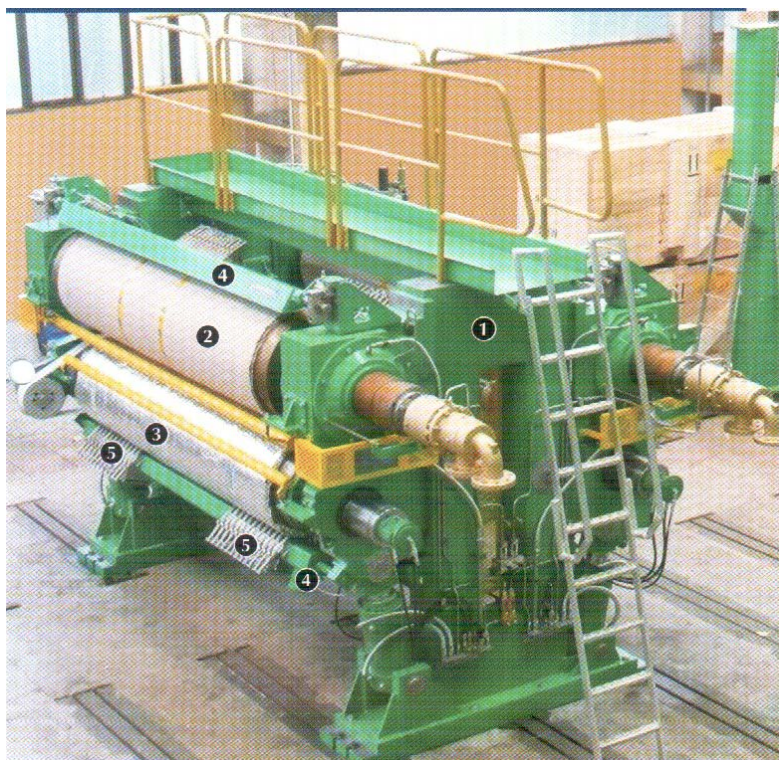
Рис. 7.4. «Мягкий» каландр: 1 – несущая конструкция; 2 – термовалы; 3 – плавающие валы; 4 – шаберы; 5 – устройство для охлаждения кромок; 6 – измерение температуры
