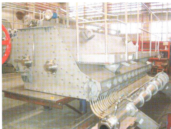
Рис. 4.2. Напорный ящик закрытого типа с многотрубным коническим коллектором
