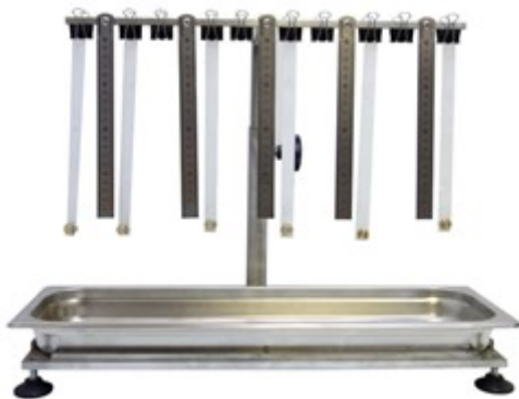
Рис. 20. Аппарат для определения капиллярной впитываемости бумаги
