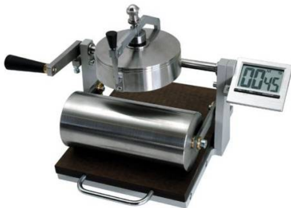
Рис. 19. Устройство для определения впитываемости при одностороннем смачивании по методу Кобба
