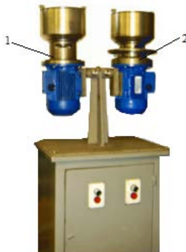
Рис. 3. Лабораторный размалывающий комплекс: 1 – гидроразбиватель; 2 – дисковая мельница
