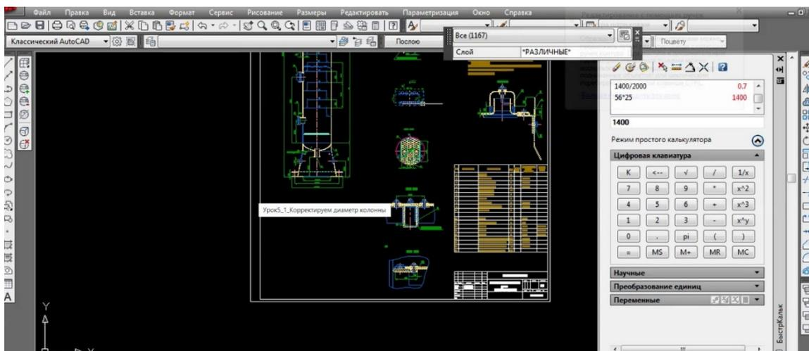
Рис. 3.18. Проверка размеров в различных видах и разрезах ректификационной колонны
