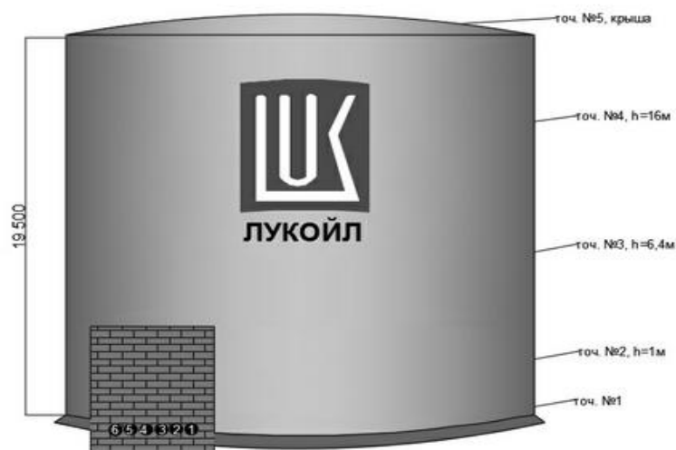
Рис. 2 - Точки замера температур и плотностей теплового потока на мазутохранилищах
