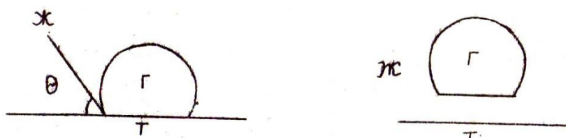
Рис. 26. Схема отрыва пузырька от поверхности твердого тела
