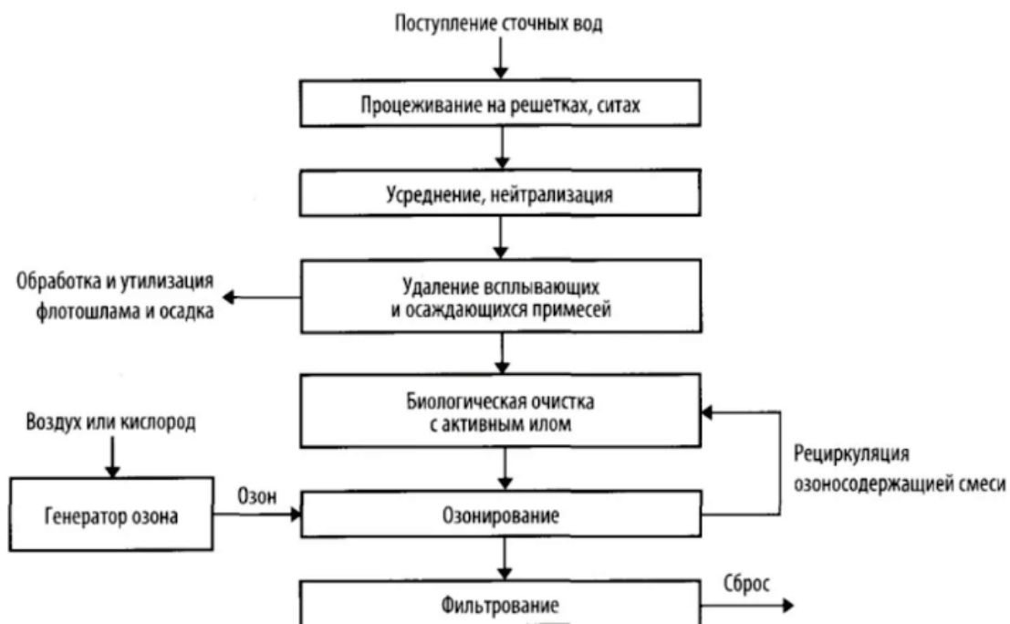
Рис. Технологическая схема очистки сточных вод текстильного производства
