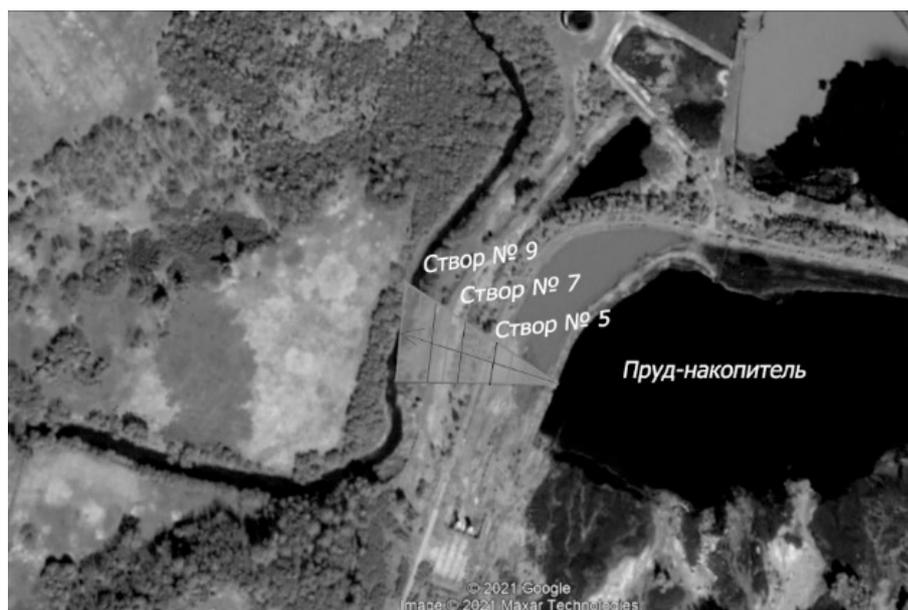
Рисунок. Зона затопления при аварийном разрушении дамбы пруда-накопителя
